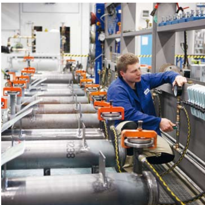
Hydraulische und elektrische Überprüfung aller Geräte am computergesteuerten Prüffeld. Die Daten aller Produkte werden lückenlos protokolliert
