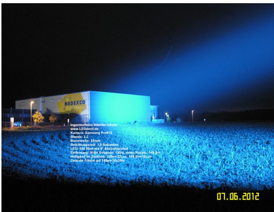
160 Watt und 5° Abstrahlwinkel (Farbtemperatur: 460nm - blau), Entfernung 150m
