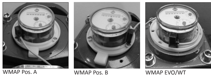
Fig. 3 Installazione del sensore/Installation of the pulser/Installation du transmetteur/Montaje del emisor
