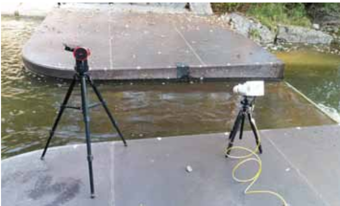
Cámara empleada para la grabación de la película y el Disto S910 para el estudio de los puntos de control terrestres.
