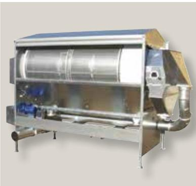
Tambour rotatif équipé de 2 niveaux de tamis. Les tamis intérieurs retiennent les grosses impuretés et les tamis extérieurs évacuent les impuretés les plus fines.
