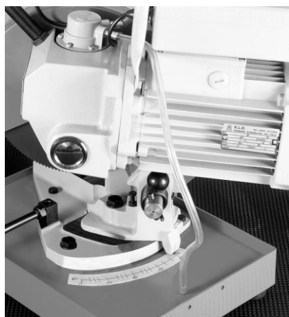
KMS MINI : Réglet gradué et système de lubrification
