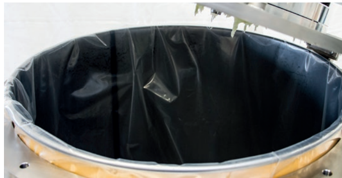
Vakuumpannfass mit Inliner vor dem Einschalten der Vakuumpumpe Vacuum drum with inliner before switch-on the vacuum pump
