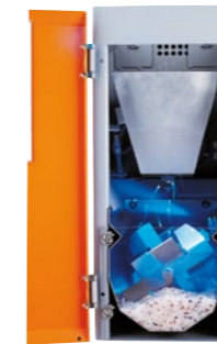
称重料斗和混料室
