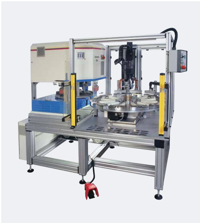
CONCENTRA 90-4 mit Rundschteller und Lichtvorhang Bremscheiben
