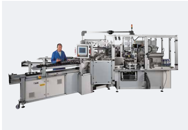
Automation Montage/Prüfung und Lasermarkierung Blenden Kfz-Armaturen
