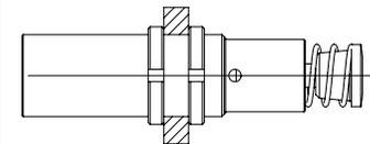
Tightening torque: 820 Nm
