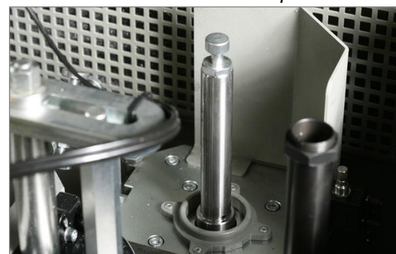
"Changement rapide pneumatique de l'arbre porte-fraise"
