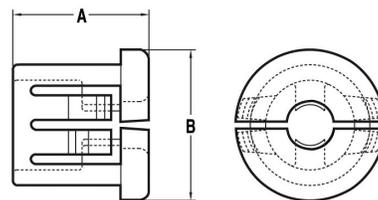
Facile à installer d'une simple pression des doigts. Blocage du câble par pincement. Action de protection des câbles mais aussi allègement de la traction sur le câble. Épaisseur maximale des panneaux de 3,2 mm.
