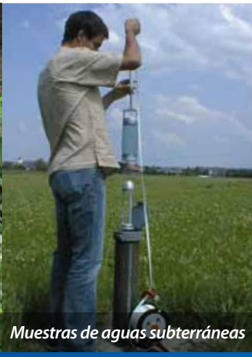
Medición de nivel de agua
