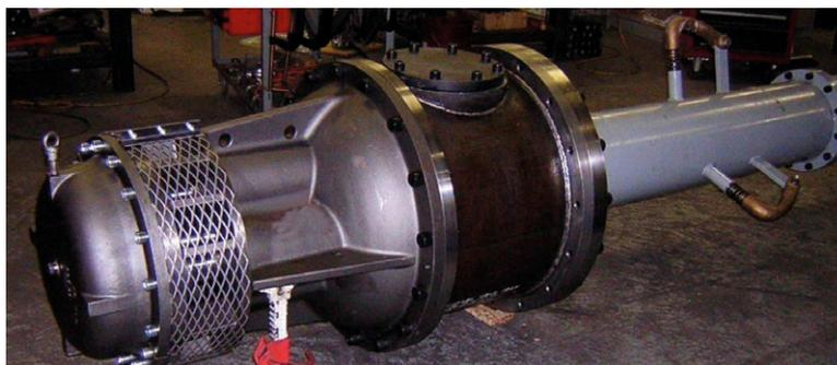
Fig. 5: Pump „suction side view“
