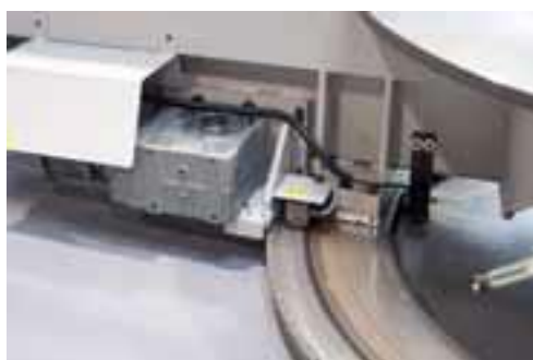
Rotation motorisée de l'archet de sciage avec blocage pneumatique
