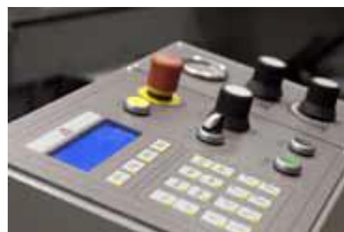
Pupitre de commande mobile, indépendant de la machine
