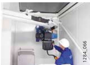
Sistema apto para curvas con un ángulo de 15-360°
